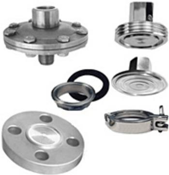
Os selos de proteção do tipo diafragma são acoplados para isolar e proteger o instrumento de medição do processo. Separando o instrumento dos fluídos corrosivos, viscosos, com sólidos em suspensão, nos processos tóxicos, nas temperaturas excessivas, etc. Modelos de fácil remoção para limpeza quando utilizados em alimentícias ou farmacêuticas. Sua principal característica é evitar incrustação ou contaminação nos fluídos de medição.
