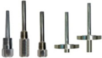
Poços de proteção são acessórios de uso indispensável em medidores de temperatura. Atuam como proteção mecânica, isolando o fluido de processo da haste sensora do instrumento. Sua utilização proporciona redução no tempo para substituição do sensor, sem a interrupção do processo produtivo e impede eventuais vazamentos.
