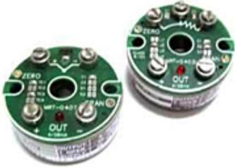
Os Transmissores de Temperatura "CONNECT-JCO" da linha MRT-0403L e MRT-0407 convertem um sinal emitido pelo sensor de temperatura do tipo Pt-100, Termopar ou sinais lineares em sinal diretamente proporcional em corrente na faixa de 4 a 20mA.
