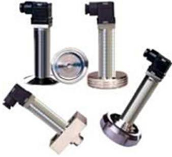
Os transmissores de nível "CONNECT-JCO" da linha CPC-9800 trabalham no mesmo princípio dos hidrostáticos ( $P = \text{Densidade do Fluido} \times \text{Altura do Tanque}$ ). Ideal para tanques externos, onde pode ser instalados na parte inferior dos mesmos e até em fluídos c/ temperaturas elevadas. Podem ser fornecidos c/ Indicação Local e Relê de Controle para controle do nível.
